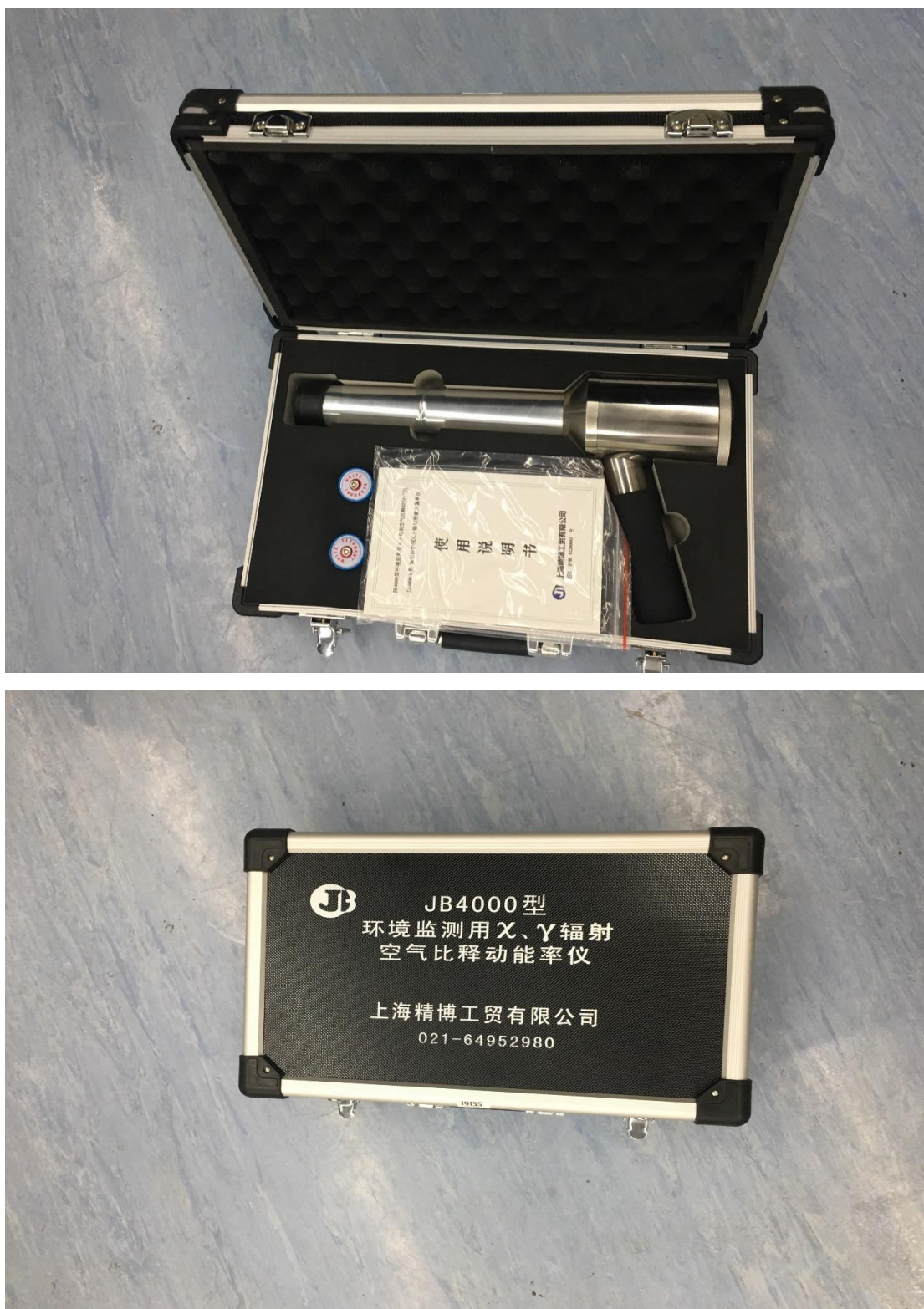
JB4000 型环境监测用 X、 \gamma 辐射空气比释动能率仪
